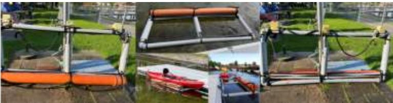
Ein sicheres Ein- und Aussteigen für alle Menschen jeden Alters sowie mit Einschränkungen und Handicap bietet diese leicht nach zu bauende Einstiegshilfe mit Materialien aus dem Baumarkt. Verbaut wurden sogenannte HAT-Rohre (Abwasserrohre), die mit Gurtbändern gesichert sind. Mit dieser Einstiegshilfe ist ein sicherer Ein- und Ausstieg für Menschen mit
