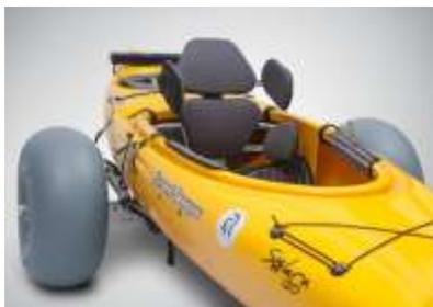
Dieses einzigartige Design ermöglicht den Transfer auf einer ebenen Fläche (wie einem Parkplatz), indem der Cockpitrand auf Rollstuhlhöhe positioniert wird. Mit dem Paddler im Kajak kann das Rig ins Wasser gerollt und vom Wagen getrieben werden – wodurch die meisten
