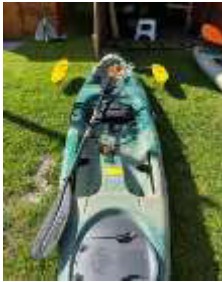
Abb. 66 Selbstbau-Ausleger am Kajak (Heinz Ehlers)
